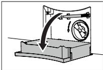
► Faire basculer le récipient d'écoulement complètement vers le bas. Procéder si nécessaire à une vidange d'urgence.
