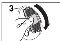
► Insérer le piège à corps étrangers **3** jusqu'à la butée.
