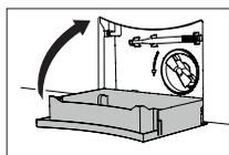
► Remettre en place le récipient d'écoulement et le refermer.
